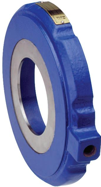
El ensamble de Plato de Orificio de Cla-Val modelo X52E es utilizado típicamente con las válvulas de control de flujo de Cla-Val. El plato de orificio es un componente esencial utilizado para generar una caída de presión en el sistema, específica y predecible. El modelo X52E utiliza un retenedor tipo wafer que ofrece un ensamble compacto y ligero que es muy fácil de instalar. El modelo X52E tiene un lado biselado, así que aun después de instalado, se puede verificar su correcta instalación.
