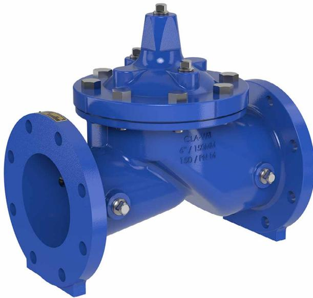
La válvula Hytrol Cla-Val modelo 100-20 es de operación hidráulica, actuada por diafragma, tipo globo o ángulo. Consistente en tres componentes principales: cuerpo, ensamble de diafragma y tapa. El ensamble de diafragma es la única parte con movimiento.
