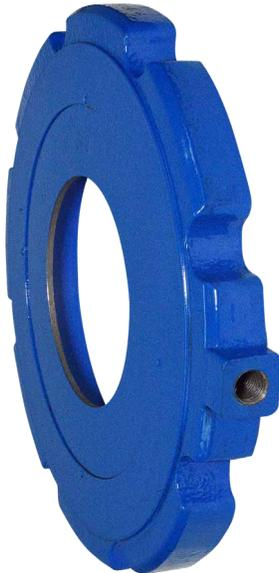
El ensamble de Plato de Orificio de Cla-Val modelo X52E es utilizado típicamente con las válvulas de control de flujo de Cla-Val. El plato de orificio es un componente esencial utilizado para generar una caída de presión en el sistema, específica y predecible. El modelo X52E utiliza un retenedor tipo wafer que ofrece un ensamble compacto y ligero que es muy fácil de instalar. El modelo X52E tiene un lado biselado, así que aun después de instalado, se puede verificar su correcta instalación.
