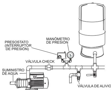
El tanque precargado debe instalarse lo más cerca posible del presostato (a 60 centímetros o menos), a fin de reducir los efectos adversos de las pérdidas por fricción y las diferencias de elevación.
