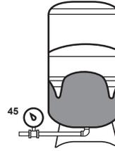
4. La presión en la cámara de aire fuerza la entrada de agua al sistema cuando se demanda, sin que la bomba funcione de inmediato. Cuando la presión finalmente disminuye al nivel de activación de la bomba, el interruptor la pone en funcionamiento para que se repita el ciclo de llenado.
