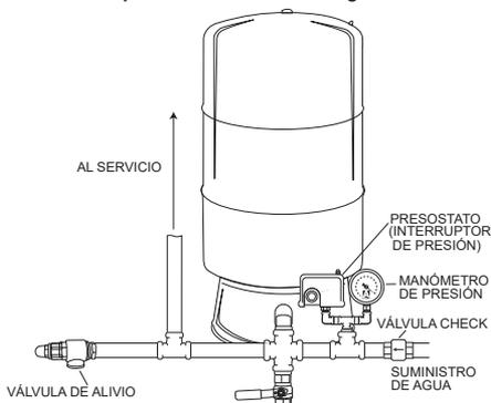
Instalación típica de una bomba de superficie
