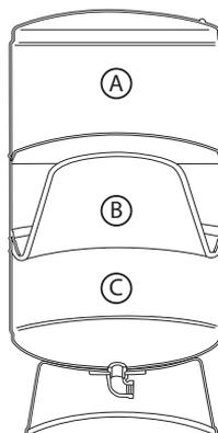
Los componentes del tanque precargado en alta presión son: un tanque de acero (A) que contiene un diafragma de uso rudo sellado para alta presión (232 PSI) en su lugar (B) que separa el aire del agua. La porción del tanque donde se almacena el agua (C) está recubierta para aislar el agua del metal del tanque y así protegerlo contra la corrosión.
