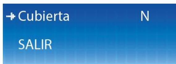
Una vez activado el sistema de detección de cubierta, se le requerirá seleccionar el tipo de sensor de final de carrera que tenga instalado, ya sea normalmente abierto (n.o.) o normalmente cerrado (n.c.)
