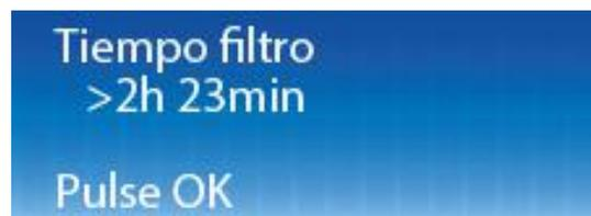
Si al final del día, la bomba de filtración permanece menos horas en funcionamiento del que estipula el equipo para que haya un nivel de cloro óptimo en el agua, el equipo mostrará un mensaje de advertencia.
