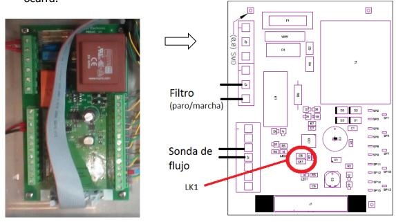
Figura 3.3: Placa de conexión auxiliar
