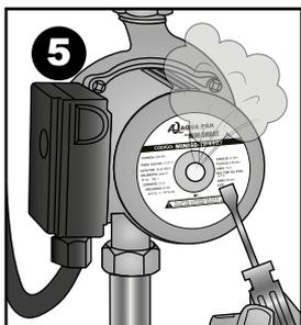
Remover el aire a través del tornillo hasta comprobar que el agua está libre de aire
