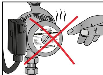
Nunca debe tocar la bomba cuando este en funcionamiento (la temperatura de funcionamiento del motor puede ser alta)
